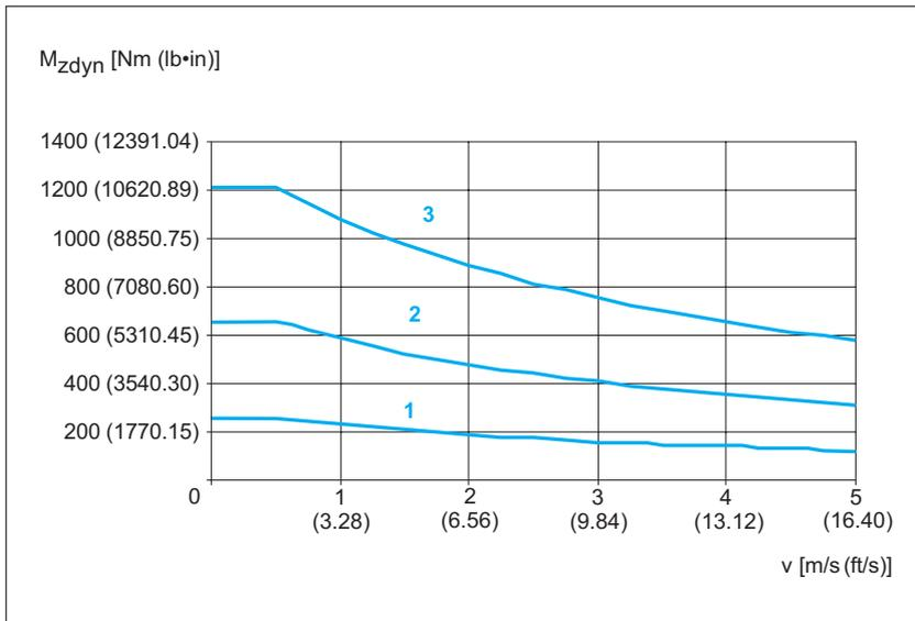
Figure 64: PAS44BB Maximum torque carriage  $M_{zdyn}$
