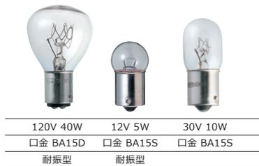
電球は、フィラメント（金属の細い線）に電流が流れることによりおこる温度放射を利用したもので、フィラメントとしてタングステン線をコイル状にしたものを使用し、ガラス球内には不活性ガス（アルゴンなど）が注入されています。電球は使用電圧が変動しますと、明るさや寿命などの特性も大きく変動する性質があります。一般のガス入り電球では、概ね次のような状況になります。
