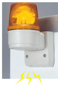
断続音、連続音に、それぞれ速いビブラートを、内蔵ディップスイッチで切り換えます。また、音量ボリュームを内蔵していますので、約70dB~90dBの範囲で調節できます。ブザー用にもコネクタを装備していますので、回転灯と同様のラクラク結線で、回転灯とブザーを別々に制御できます。
