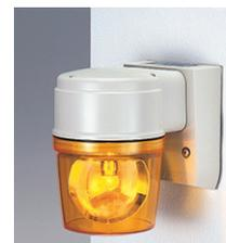
高い位置に設置する場合に、下方から認識しやすいよう、本体を逆に取付けることもできます(写真参照)。ASLBも、プレートを正方向に取付けた場合、IP23です。プレート部分にブザーを内蔵しているため、逆さ取付けでも雨滴や埃が浸入しにくく、屋外でもお使いいただけます。
